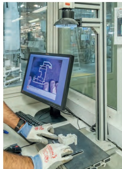
Le laboratoire de contrôle de qualité permet de vérifier la colorimétrie et la conformité de la forme du profil.
