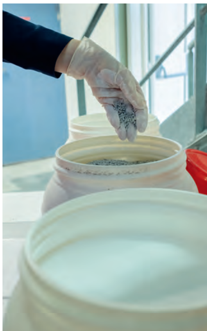
Le Dry Blend, PVC extrudable en poudre, est formulé à 80% de résine de PVC, dans laquelle sont ajoutés des additifs.
