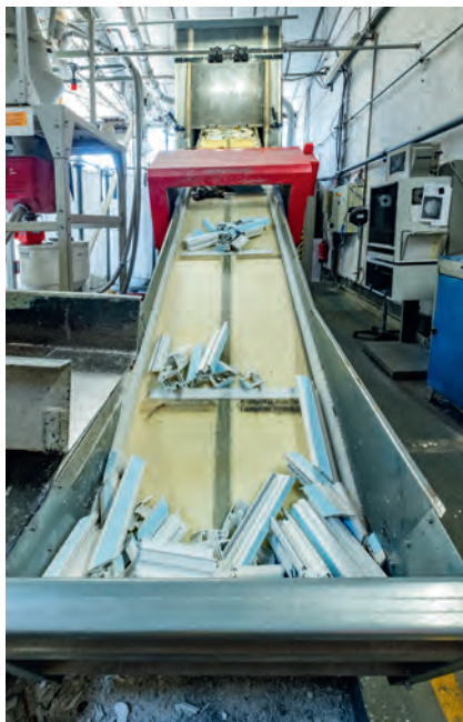
La partie blanche du profilé représente la peau en PVC vierge, et la partie bleue (pas représentative dans la réalité) représente le cœur en PVC broyé.
