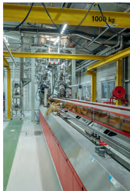
La nouvelle ligne d'extrusion ultra moderne à double peau et double sortie : une première européenne.
