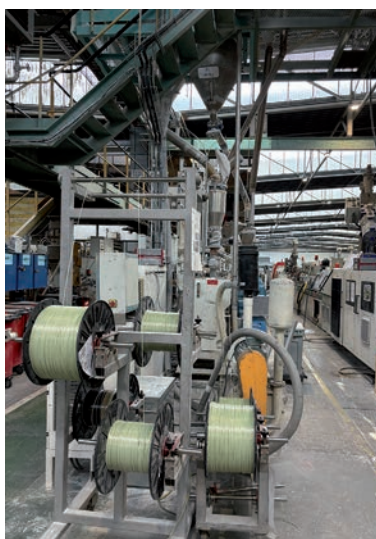
Parmi les savoir-faire industriels d'Alphacan : un outillage breveté qui permet l'extrusion intégrant des joncs de 2 mm de fibre de verre dans le profilé PVC.
