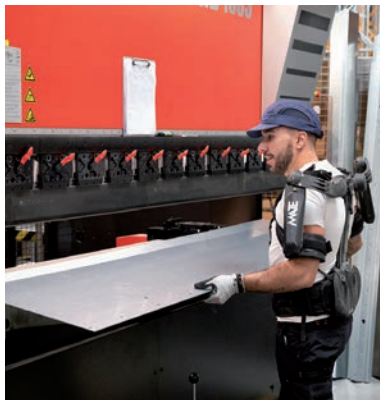
2. Pour soulager le conducteur de la plieuse récente, destinée aux plus grandes pièces, un exosquelette de posture reprend une partie des charges. © Accédia
