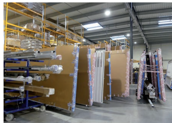
8. En fin de fabrication, tous les composants d'une porte sont rassemblés sur un chariot. L'usine peut stocker jusqu'à 45 portes en instance de départ. L'usine expédie 17 à 18 portes par jour.
