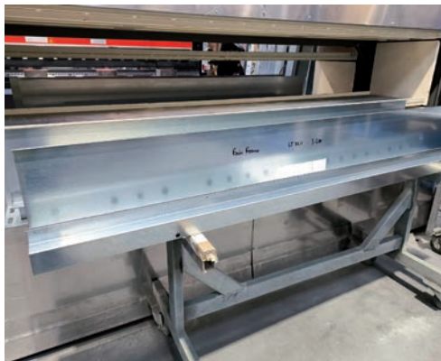
1. Une tôle de grandes dimensions pour former un poteau pèse jusqu'à 40 kg. © PP
