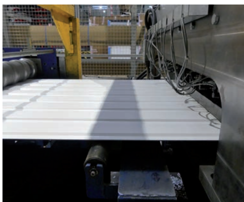
3. Pour fabriquer les tabliers, l'usine consomme en moyenne une bobine d'aluminium de 3,2 à 3,4 t par semaine. Cette tôle de 63/100ème est livrée prélaquée des deux côtés. Elle passe d'abord dans une machine qui forme les ondes sur le tablier.
