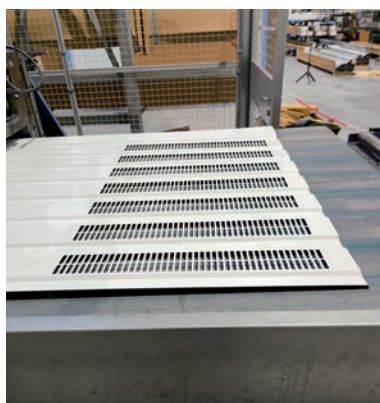
4. Une fois les ondes formées, une poinçonneuse perce, dans les tabliers, les orifices des portes ventilées. © PP
