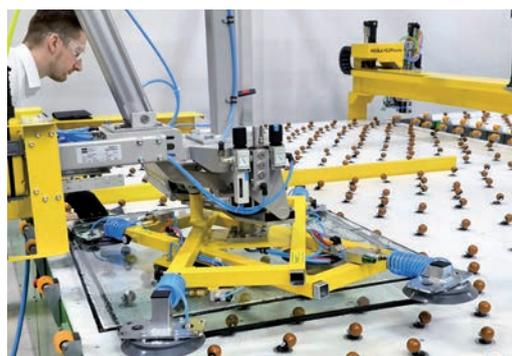
Troisième opération, les deux verres sont séparés et transférés directement à un stockage vertical. Le but de l'opération est d'atteindre une pleine automatisation pour minimiser l'intervention humaine. Le prototype exposé à Glasstec s'en rapproche rapidement. Doc. PP
