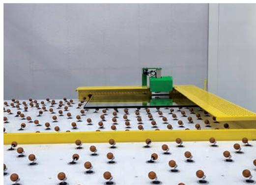
La séparation d'un verre isolant double vitrage commence par une phase d'analyse du complexe à séparer : prise des cotes et, grâce à divers capteurs, analyse précise des couches des deux plaques de verre. Les informations collectées nourrissent la machine et orientent déjà les possibilités de réemploi du verre. Doc. PP
