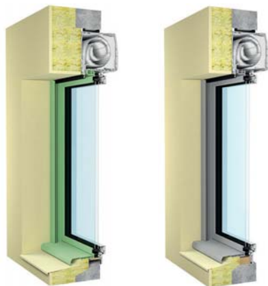
Pose au nu intérieur selon K.Line (avec Bloc Classic).
