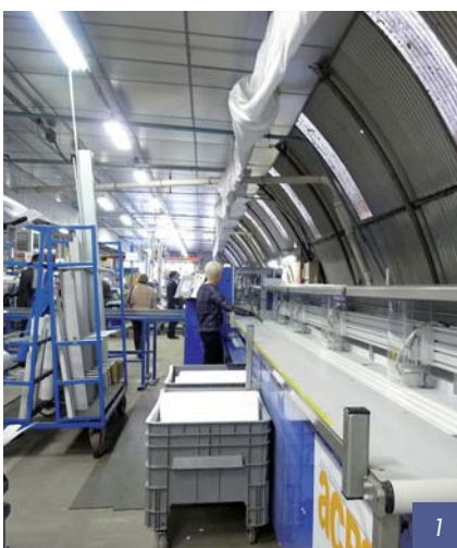
1 - Ligne automatisée de coupe des lames et assemblage des tabliers de volets roulants.
