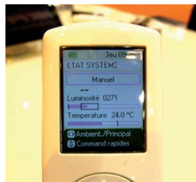
Commande Senso, à capteur de luminosité et température intégré. Cherubini.
