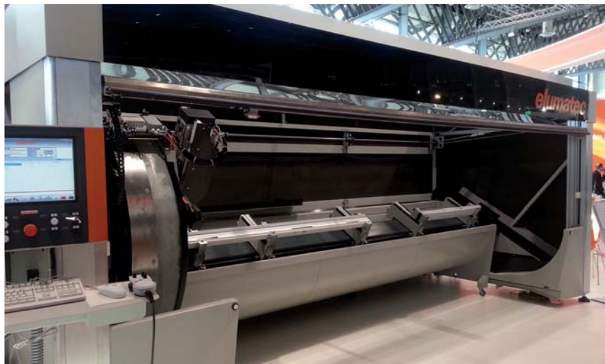
Centre d'usinage Elumatec SBZ137, lauréat du Palmarès Innovation d'EquipBaie.
