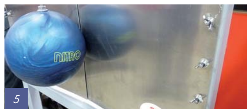
1 - 4 - Test de productivité : l'assemblage par VHB est 2 fois plus rapide que le rivetage.
