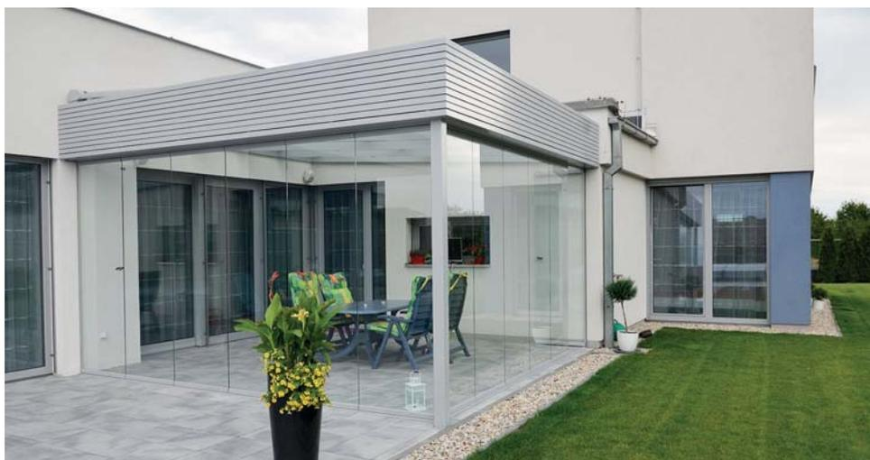
SF30, 1<sup>er</sup> système coulissant-pivotant dont le poids est transféré sur les rails au sol. Sunflex.
