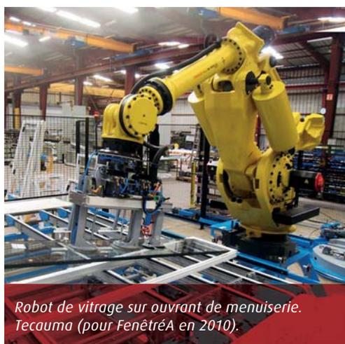
Robot de vitrage sur ouvrant de menuiserie. Tecauma (pour FenêtréA en 2010).
