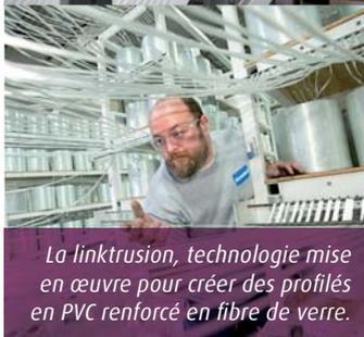
La linktrusion, technologie mise en œuvre pour créer des profilés en PVC renforcé en fibre de verre.
