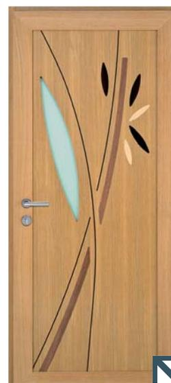
28 couleurs (selon les modèles). Côté performances, une très haute isolation thermique (CITE, Eco-PTZ, TVA5,5%) : Ud de 1,1 à 1,8 W/m<sup>2</sup>.K ; une excellente étanchéité A.E.V. : A\*3 E\*7B V\*A2 ; un seuil à rupture thermique (accès PMR). Côté sécurité : Ouvrant monobloc de 81mm (âme isolante de 68mm ou triple vitrage feuilleté et trempé dépoli acide), Crémone de sécurité avec 6 points de verrouillage, Ferrage par paumelles réglables tridimensionnelles 2 brins 6 broches.
