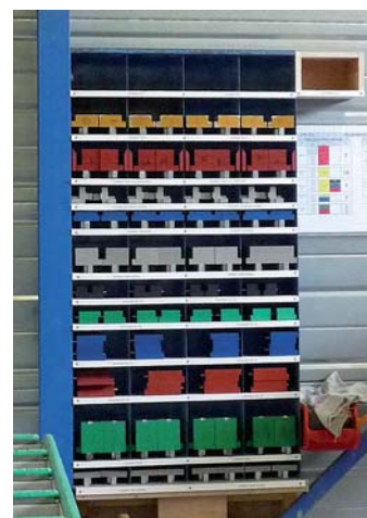
Des cales de couleurs différentes favorisent la performance de la soudure.
