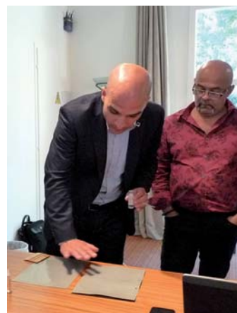
Essai de primaires : le produit solvanté appliqué en couche 5 fois plus épaisse sèche plus vite que le Low VOC.
