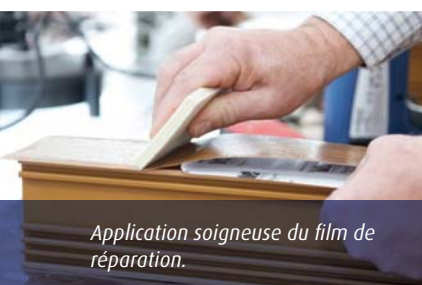
La réparation se fait toujours de l'intérieur.
